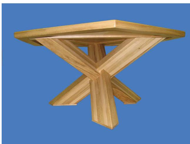
Les 6 carrelets du pied sont réalisés à partir de 3 éléments de 850 x 70 x 22 collés ensemble, puis rabotés à 850 x 64 x 64.
